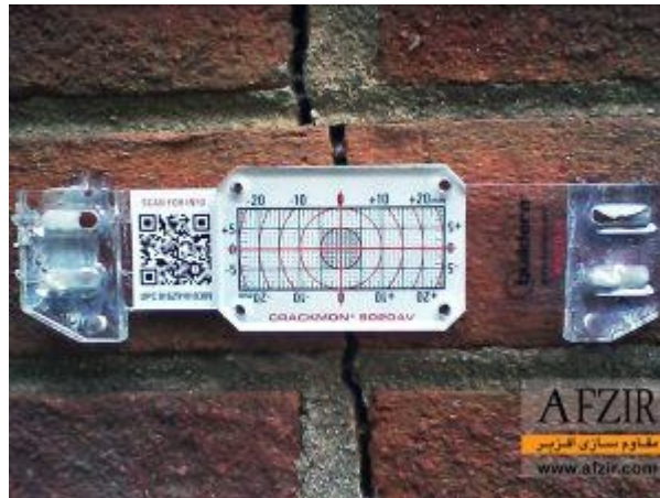
بررسی ترک به روش Plastic Tell Tale
